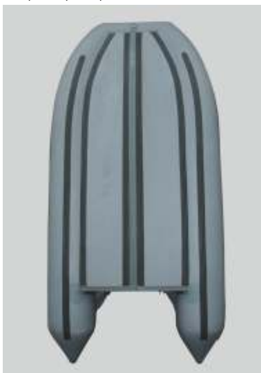
Дополнительная защита днища, стрингера, транца, баллонов
